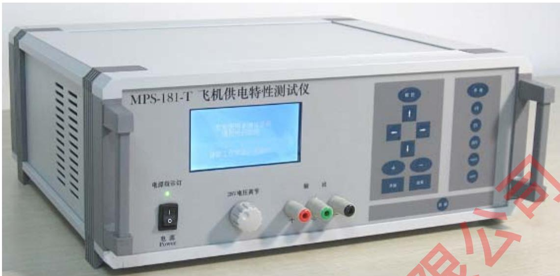
28VDC 直流测试样机
