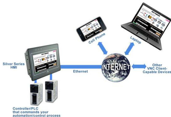
图 11 VNC 远程监控功能示意图
