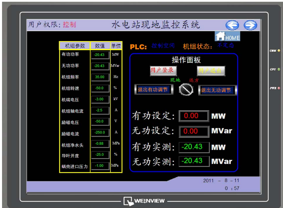
图 7 P/Q有功无功调节控制
