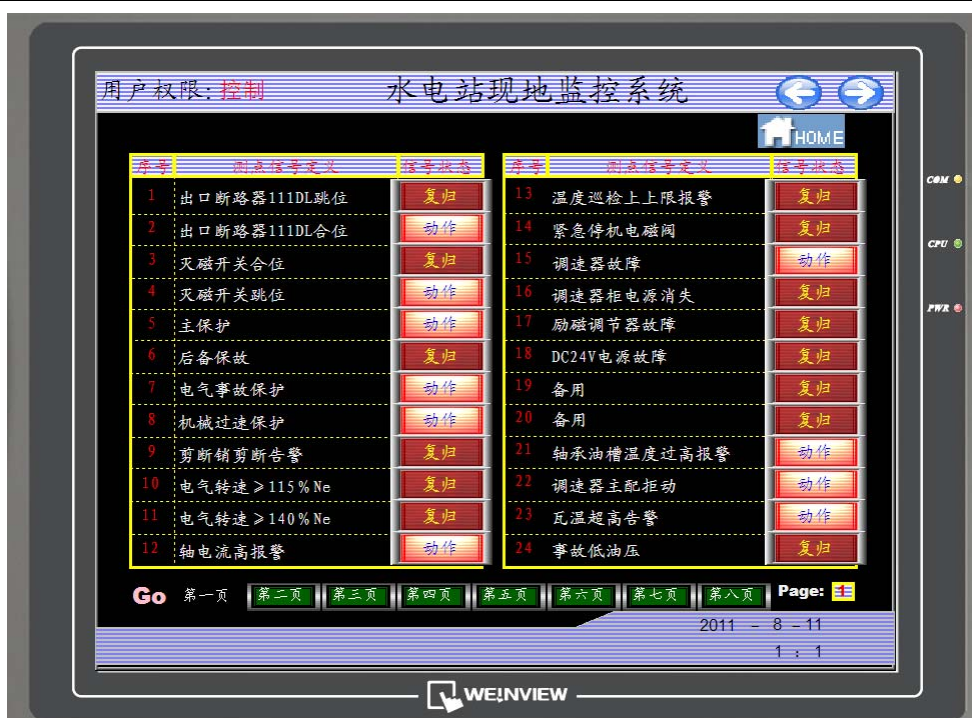
图 9 开出量、事故、故障、开入量状态显示
