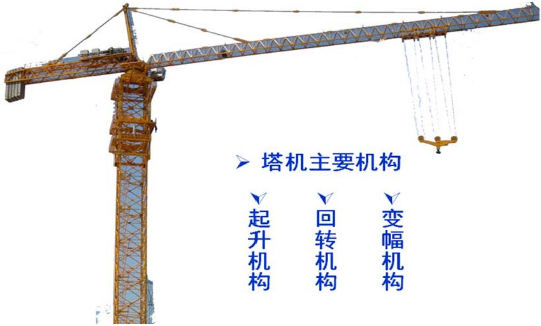
采用麦格米特 MC200-3232BRA 作为主模块，控制塔吊的动作和逻辑功能；扩展 MC200-CGP，实现远程定位设备，远程监控设备运行状态，远程升级调试用户程序、短信修改设备数据和接收警报等需求。
